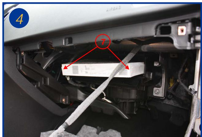
Retirer le filtre usagé et remplacer-le en veillant à positionner les 2 rabats vers le haut (7).
