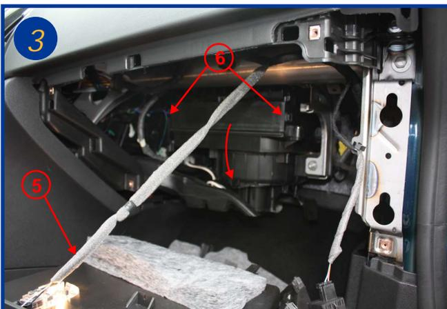
Sortir le bloc boîte à gants dans sa totalité, il n'est pas nécessaire de débrancher l'éclairage (5).
