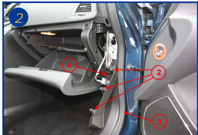
Démonter le flanc droit de la planche de bord en exerçant une pression assez forte (clips métalliques) (2) ne pas débrancher la commande de l'air-bag.
