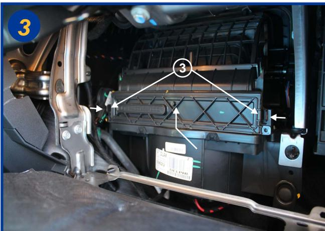
Appuyer sur les languettes (3) placées de chaque côté du boîtier filtrant pour ouvrir celui-ci. Il est dans sa partie supérieure articulé, il suffit de le soulever.
