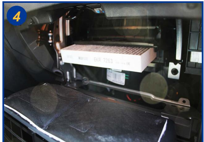
Extraire le filtre usagé et le remplacer. Le remontage s'effectue dans l'ordre inverse du démontage.
