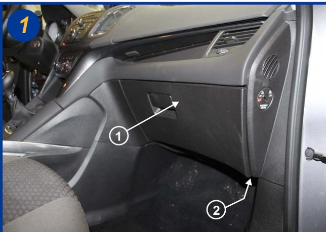
Le filtre habitacle est situé à l'intérieur du véhicule, coté passager derrière la boîte à gants (1).
