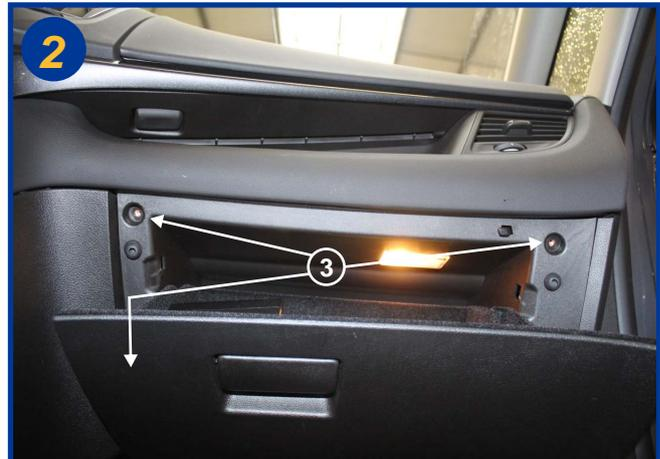
Ouvrir la boîte à gants et dévisser les 3 autres vis de 5,5 mm (3), déboîter l'ensemble de la boîte à gants puis débrancher l'éclairage de celle-ci.
