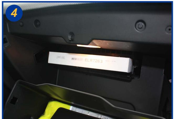
4 Extraire l'élément filtrant usagé et procéder à son remplacement. Le remontage s'effectue dans l'ordre inverse du démontage.
