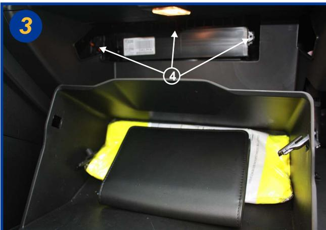
3 Ouvrir le boîtier filtrant en agissant sur les 3 pattes de fermeture (4), et basculer la trappe vers le bas.
