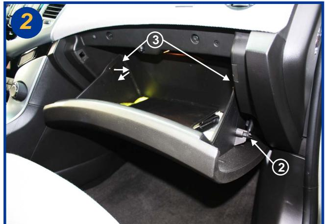
2 Ouvrir la boîte à gants, débrancher l'amortisseur de descente de boîte (2), dégager les 2 arrêteurs (3) en procédant dans le sens des flèches. Basculer le tiroir vers le bas.
