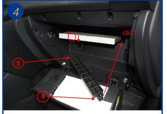
Sortir le filtre usagé, le remplacer (flèche vers le bas) replacer le couvercle du boitier en positionnant tout d'abord la patte à l'extrémité (5) et en cliquant l'autre extrémité (6). Le remontage s'effectue dans l'ordre inverse du démontage.
