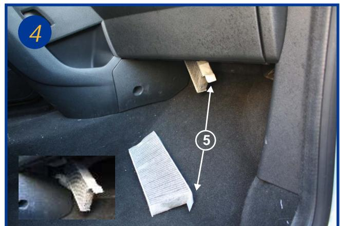
Extraire les filtres l'un après l'autre, ils sont superposés et une languette est prévue (5). Le remontage s'effectue dans l'ordre inverse du démontage.
