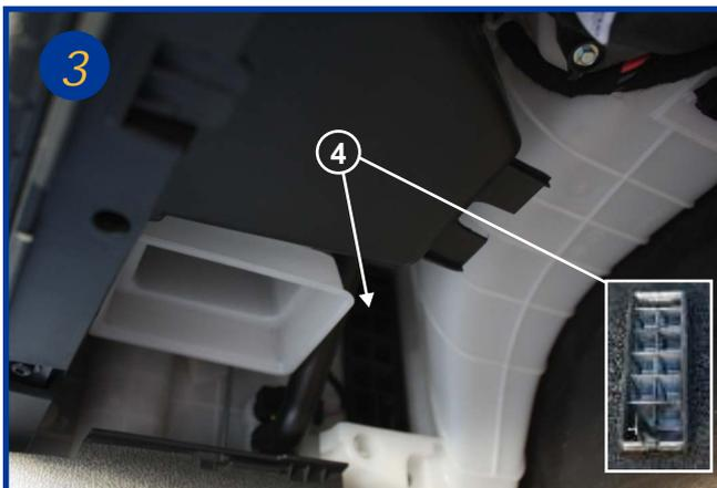
Reperer l'ouverture du boîtier (4) et le déposer.
