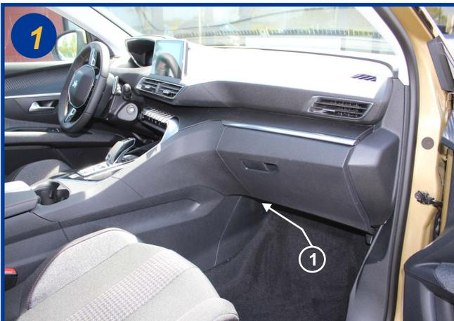
Les filtres sont situés à l'intérieur du véhicule, coté passager sous la boîte à gants coté console centrale (1).
