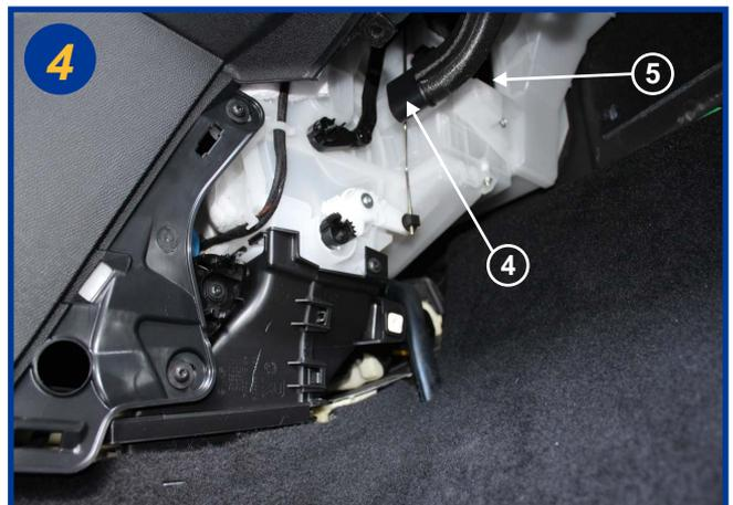
Débrancher la durite souple de ventilation (4) pour avoir un accès plus aisé au couvercle du boîtier filtrant (5).
