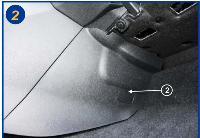
Démonter le flanc de console, pour cela retirer le cache plastique (2) à l'aide d'un tournevis plat et dévisser la vis torx (T25) puis tirer fortement pour dégrafer le carter.
