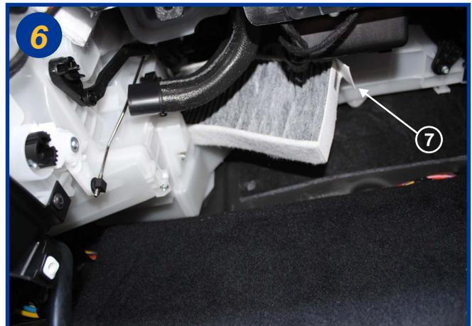
Retirer le premier élément en tirant sur la languette fixée sur le filtre et prévue pour cela (7).
