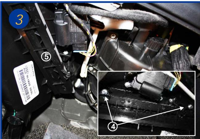
Dévisser les 2 vis (4) du couvercle du boîtier filtrant (5)
