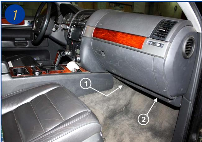
Le filtre d'habitacle est situé à l'intérieur du véhicule, coté conducteur sous la boîte à gants (1).
