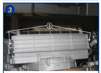
Ouvrir le boîtier filtrant en agissant sur les 2 fermoirs à gauche et à droite du couvercle (3). Extraire le couvercle.
