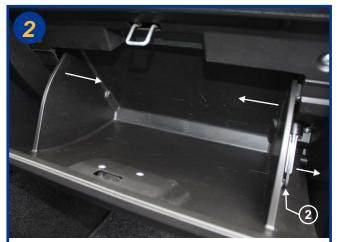
Désaccoupler le tirant de l'amortisseur de descente de boîte (2) en tirant dans le sens de la flèche. Presser sur les flancs du tiroir pour dégager les butées, dans le sens des flèches et retirer le tiroir.
