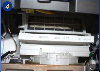
Retirer I 'élément filtrant usagé et procéder à son remplacement.
