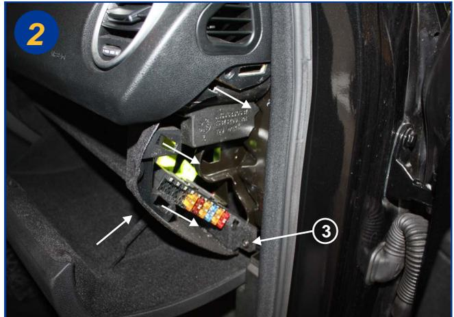
Ouvrir la boîte à gants et dégrafer le flanc (2)(photo1) en tirant fortement dessus par devant (voir flèches). Dévisser ensuite la vis Torx (T25)(3).
