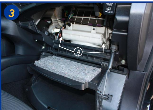
Ouvrir le boîtier filtrant en agissant sur les 2 pattes de fermeture situées aux extrémités du couvercle (4). Retirer le couvercle.
