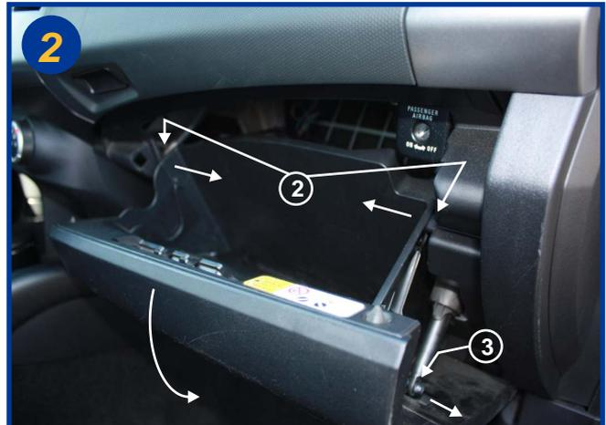
Ouvrir la boîte à gants, presser sur les flancs de celle-ci pour dégager les arrêtoirs (2) puis retirer l'amortisseur d'ouverture (3), la boîte à gants peut alors être basculée vers le bas.
