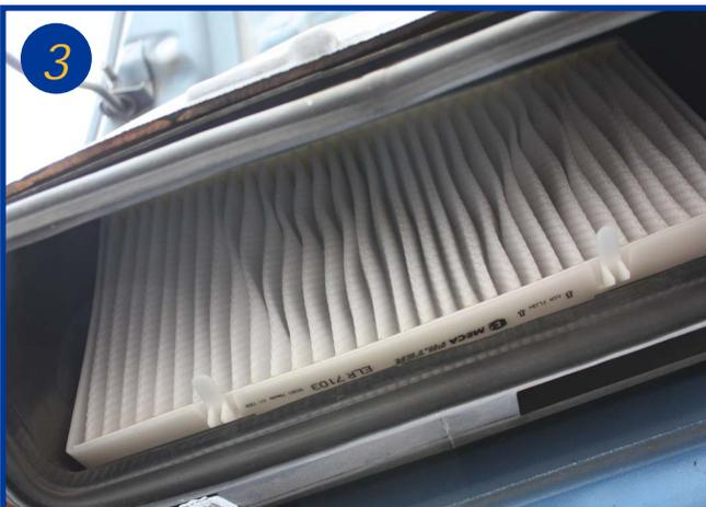
Procéder à son remplacement en replaçant les 2 ergots sur la face arrière du filtre dans le fond du boîtier. Aucun outil n'est nécessaire pour cette opération.
