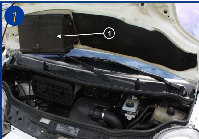
Le filtre d'habitacle est situé sous et sur le capot moteur dans le boîtier noir (1)
