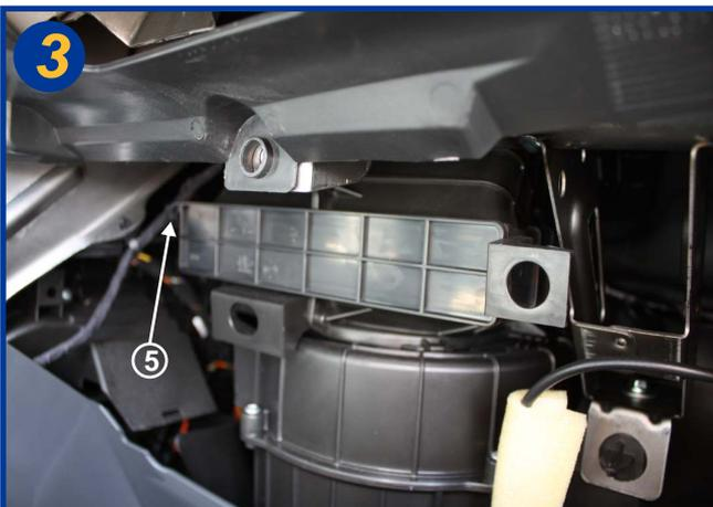
Ouvrir le boîtier filtrant par la gauche en actionnant le petit fermoir (5). Retirer le couvercle.
