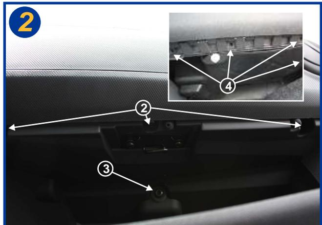
Dévisser les 3 vis Torx (T20) (2) puis la vis BTR de 5(3). Dévisser également les 4 vis Torx (T20) (4) situées sous la boîte à gants (voir encadré). Retirer dans sa totalité le bloc boîte à gants.
