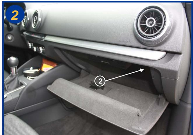
Dans le fond de la boîte à gants se positionne une trappe (2), la démonter et l'extraire totalement à l'aide de la patte plastique sur l'extrémité droite.
