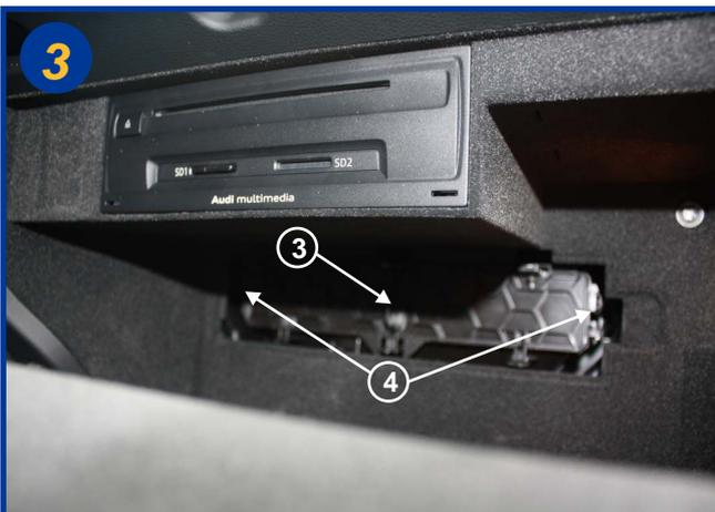
Retirer le couvercle du boîtier filtrant en tirant vers soi à l'aide de la poignée centrale (3) et en dégagant les loquets de fermeture (4) à gauche et à droite de la trappe.
