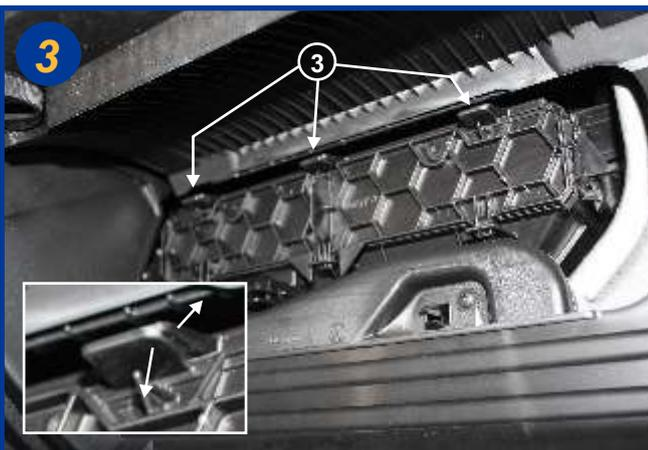
Ouvrir le boîtier filtrant en dégageant les 3 pattes (3), il suffit d'écarter les pattes (voir détail).
