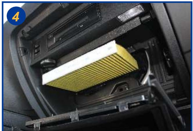
Retirer le filtre usagé et le remplacer.
