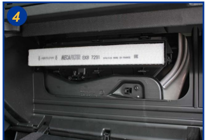
Sortir l'élément filtrant usagé et procéder à son remplacement.
