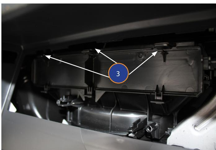
3. Ouvrir le boîtier filtrant en actionnant les tirettes (3) au nombre de 3 en partie supérieure, le couvercle étant guidé en bas, puis extraire le couvercle.
