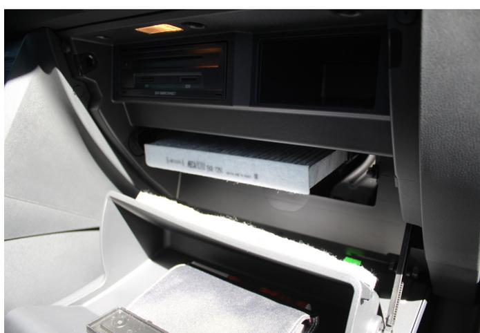
4. Sortir l'élément filtrant et procéder à son remplacement. Le remontage s'effectue dans l'ordre inverse du démontage.
