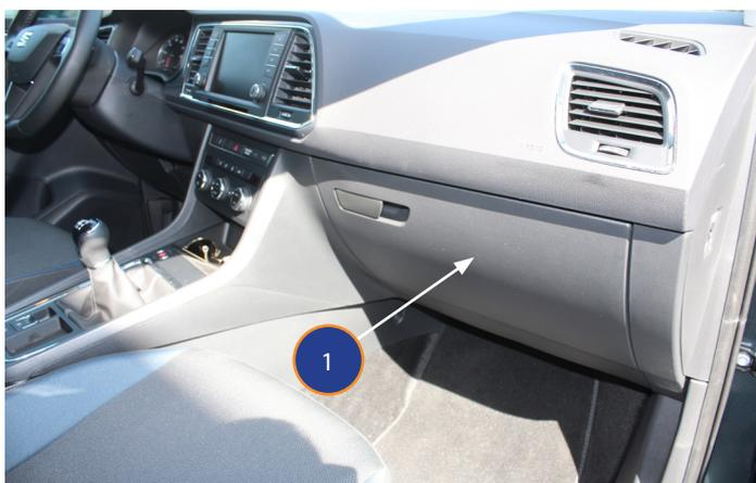
1. Le filtre d'habitacle est situé à l'intérieur du véhicule, côté passager derrière la boîte à gants. Ouvrir la boîte à gants (1).
