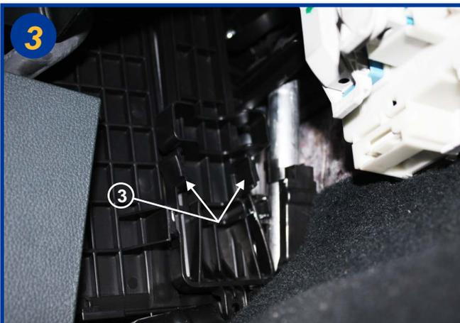
Ouvrir le boîtier filtrant à l'aide des poignées (3). Retirer le couvercle.
