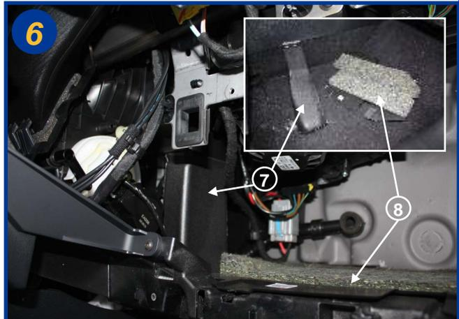
Tirer sur le conduit de ventilation (7) et le retirer, puis dégraffer le carter de protection (8) et le déposer (voir encadré).
