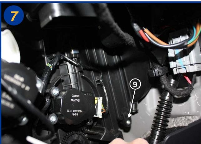
Dévisser la vis torx (T20) de fermeture du boîtier filtrant (9) et retirer le couvercle.
