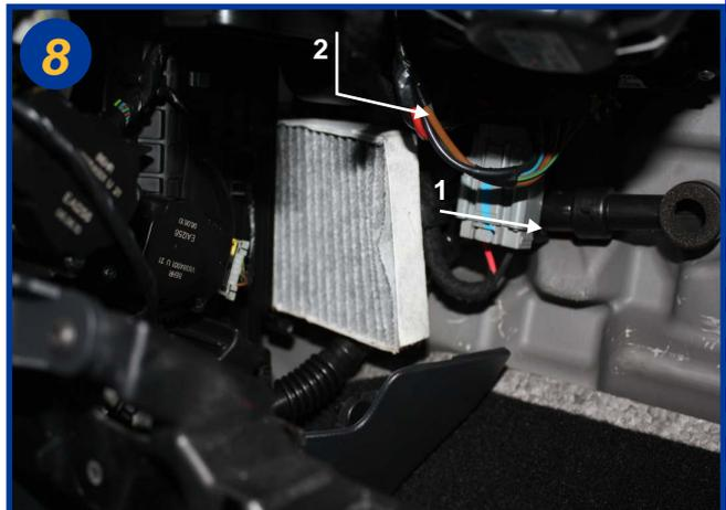
Retirer les éléments usagés et les remplacer. Il est nécessaire de les déformer pour les remettre en place. Le remontage s'effectue dans l'ordre inverse du démontage.
