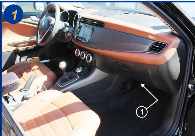
Le filtre d'habitacle est situé à l'intérieur du véhicule, coté passager, derrière la console centrale sous le tableau de bord (1).
