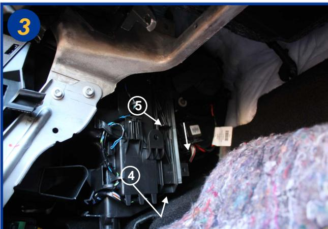
Ouvrir le boîtier filtrant en actionnant dans un premier temps le fermoir (4) pour déverrouiller, puis à l'aide de la poignée (5), faire coulisser le couvercle dans le sens de la flèche.
