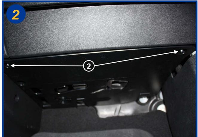
Sous la boîte à gants, dévisser les 2 écrous hexagonales de 8mm (2).
