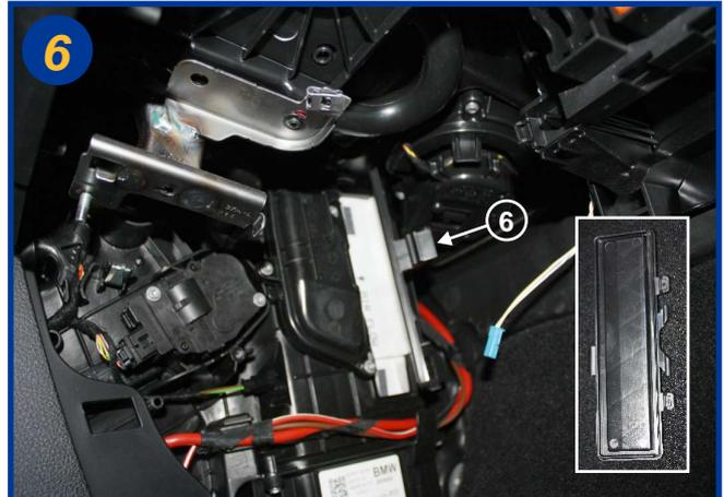
Ouvrir le boîtier filtrant à l'aide de la poignée (6) et retirer le couvercle articulé sur son côté droit.
