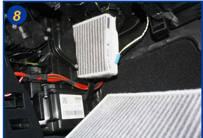
Remplacer les 2 éléments filtrants en insérant tout d'abord le premier, le faire descendre dans la partie inférieure du climatiseur puis positionner le deuxième au dessus. Le remontage des autres pièces s'effectue dans l'ordre inverse du démontage.
