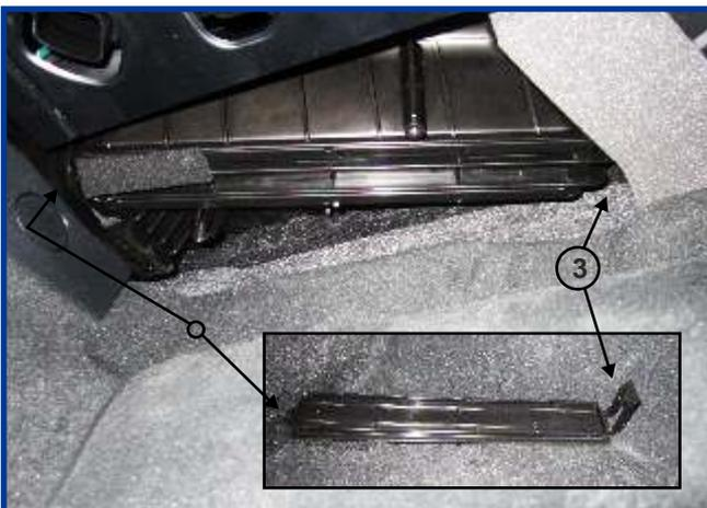
Dé-encliqueter le couvercle du boîtier filtrant (3) et le retirer.
