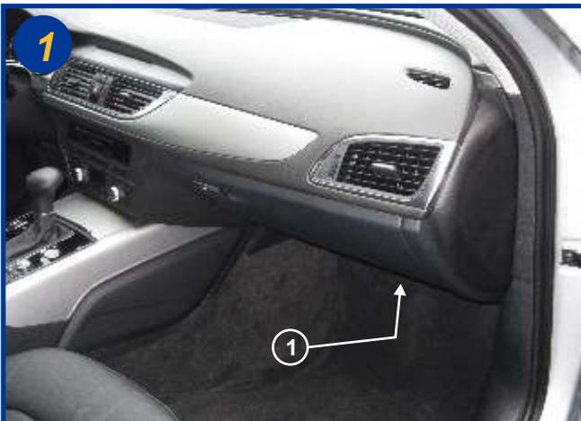
Le filtre d'habitacle est situé à l'intérieur du véhicule, coté passager et sous la boîte à gants (1).
