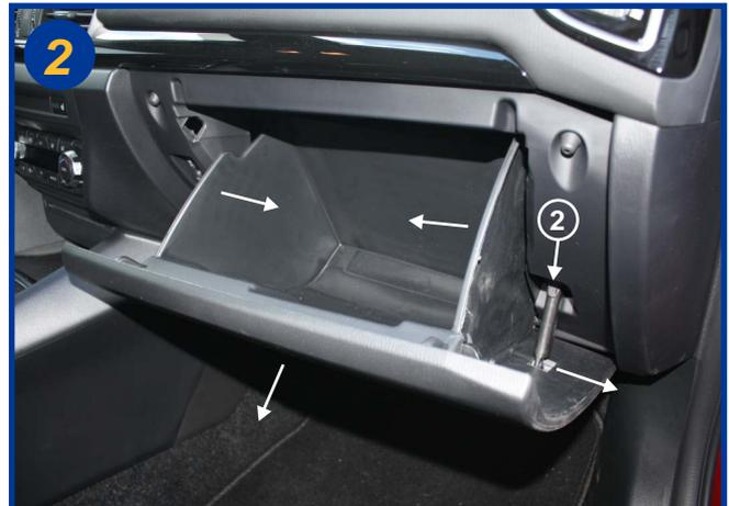
Désaccoupler l'amortisseur de la boîte à gants (2) en tirant dans le sens de la flèche, puis appuyer fortement sur les flancs de chaque côté et basculer l'ensemble vers le bas.
