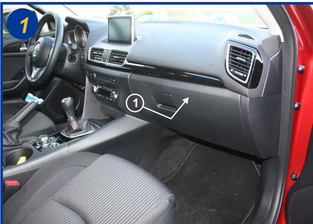
Le filtre d'habitacle est situé à l'intérieur de la voiture, côté passager derrière la boîte à gants (1). Ouvrir la boîte à gants.
