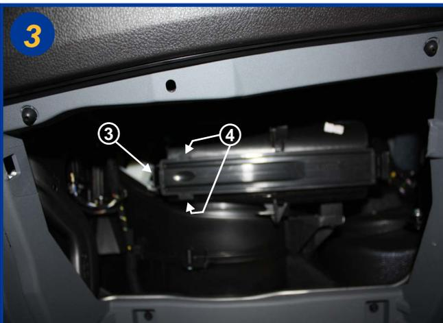
Ouvrir le boîtier filtrant par la gauche en appuyant sur le fermoir (3) et en tirant sur les 2 oreilles (4). Retirer le couvercle.
