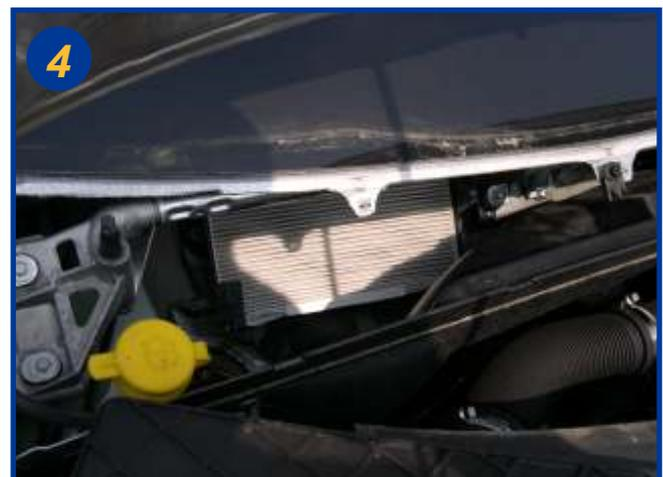
Extraire l'élément filtrant usagé en le déformant afin de le sortir de son emplacement. Le remplacer
