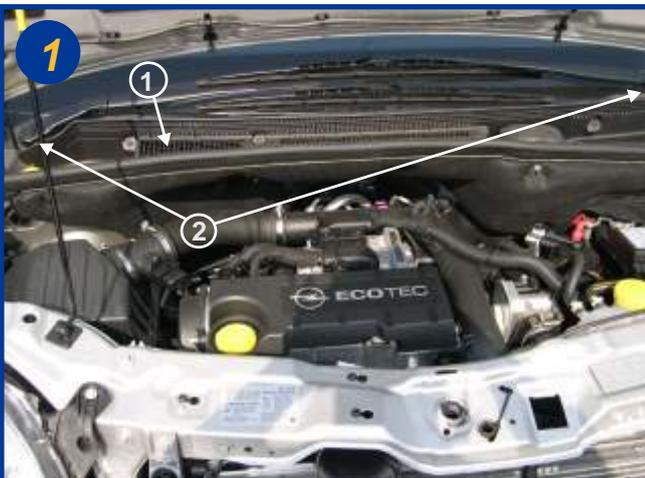
L'élément filtrant est situé sous la baie de pare brise coté passager (voir flèche 1). Ouvrir le capot moteur et retirer les balais d'essuie-glaces après avoir ôté les caches vis et les 2 écrous hexagonaux.(voir flèche 2).
