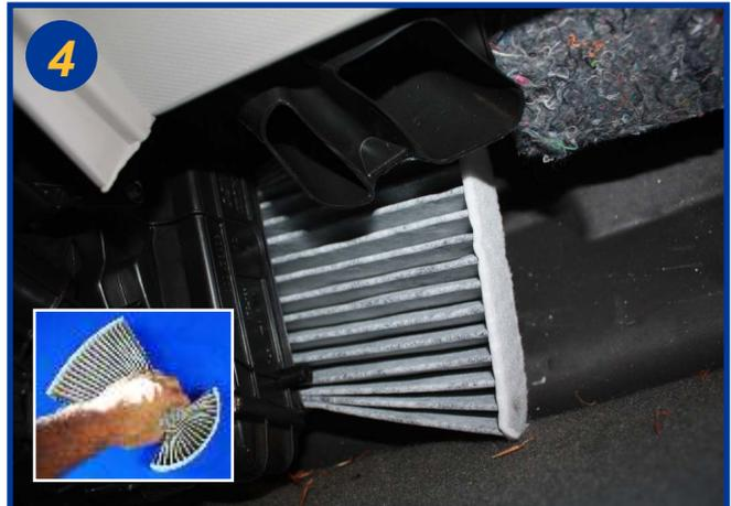
4 Le filtre de rechange est plissé horizontalement et il faut le déformer (voir encadré) pour le placer dans son logement. Le remontage s'effectue dans l'ordre inverse du démontage.
