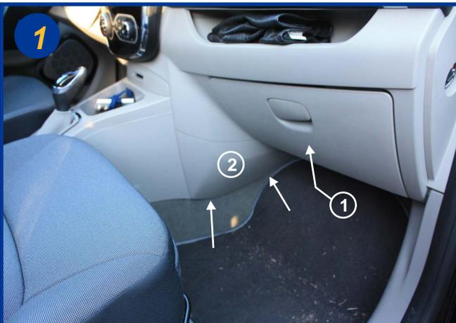
1 Le filtre d'habitacle est situé à l'intérieur du véhicule, coté passager sous la boîte à gants coté console centrale (1). Dégrafer le carter plastique (2) en partant de la base de celui-ci.
