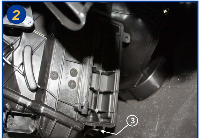
2 Ouvrir le boîtier filtrant par le dessous en écartant la patte de fermeture (3).
