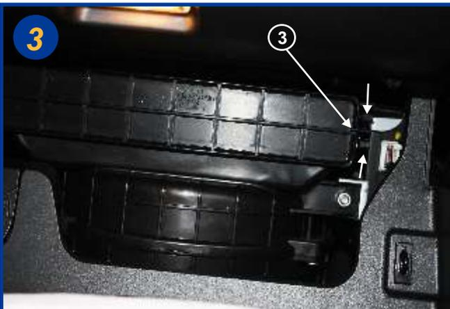
Appuyer sur les 2 pattes du fermoir (3) dans le sens des flèches pour ouvrir le boîtier filtrant.
