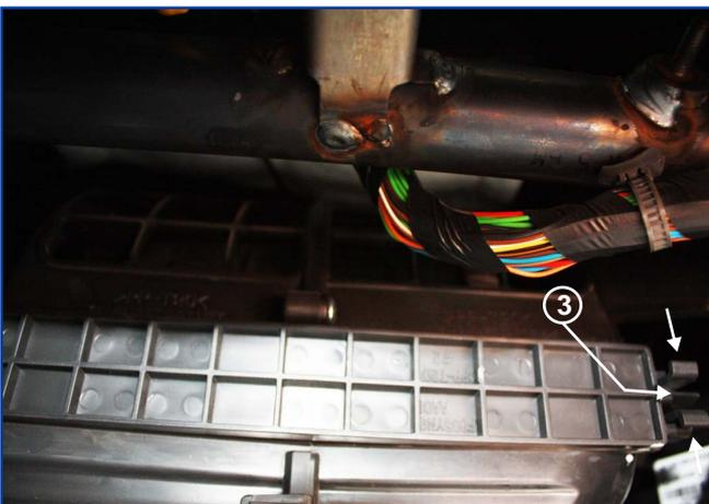
Ouvrir le boîtier filtrant (articulé sur la gauche) à l'aide de la poignée (3) dans le sens des flèches.
