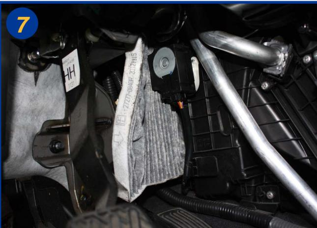
Sortir l'élément filtrant usagé, il est nécessaire de le déformer pour le sortir de son logement.
