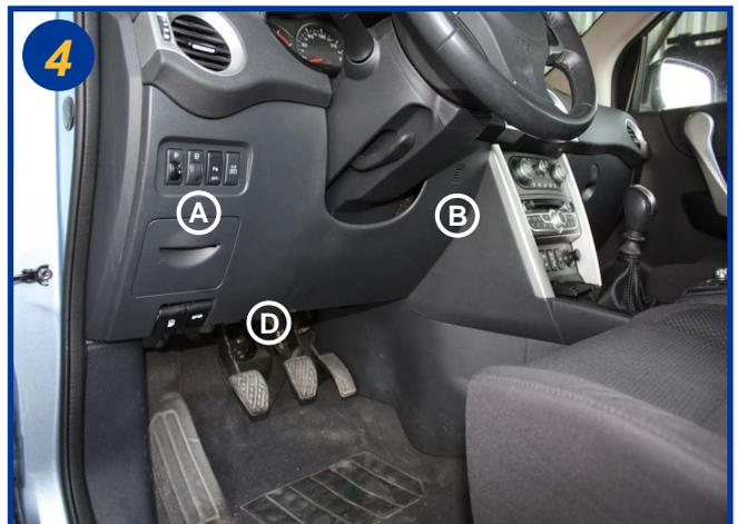
Dégrafer et retirer le plastron sous le volant, Attention beaucoup de connectiques sont reliées à ce carter, voir figure 4a qui suit pour plus de détails.
