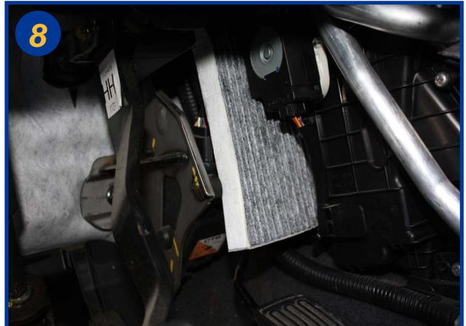
Replacer un filtre neuf en le déformant également pour qu'il reprenne sa bonne place dans le logement.
