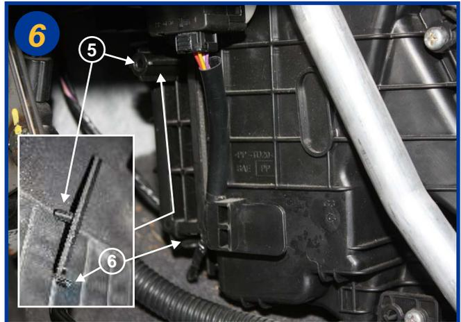
Ouvrir le boîtier filtrant à l'aide de la poignée (5) et en dépliant le fermoir (6) (voir encadré).
