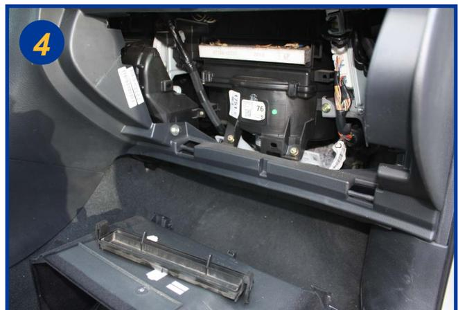
Extraire l'élément filtrant usagé et le remplacer.
