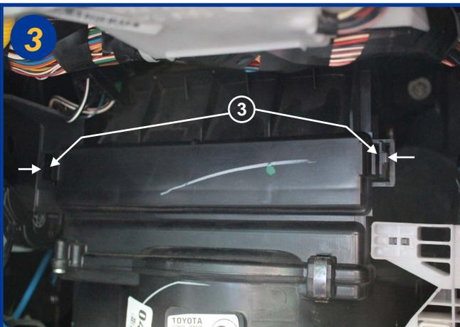
Appuyer sur les 2 languettes (3) vers l'intérieur pour ouvrir le boîtier filtrant et retirer le couvercle.
