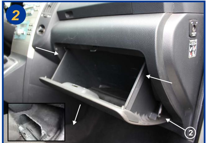
Dévisser la vis cruciforme (2) pour dé-coupler l'amortisseur de retenue de la boîte à gants. Presser sur ces flancs (voir flèches) et retirer dans sa totalité le tiroir de boîte (voir encadré)
