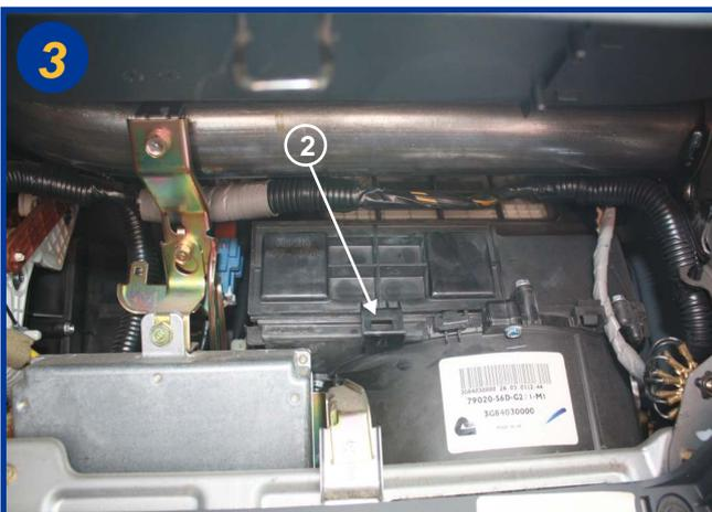
Ouvrir le boîtier filtrant en soulevant le fermoir (2) et retirer le couvercle.
