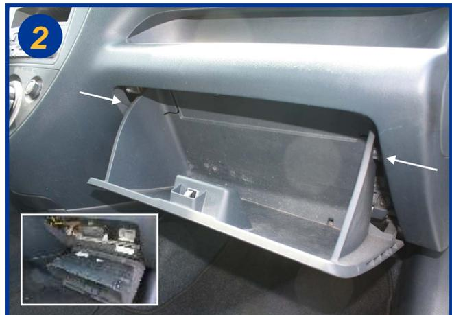
Presser sur les flancs du tiroir de boîte pour dégager les butées d'ouverture dans le sens des flèches et basculer le tiroir vers le bas (voir encadré).
