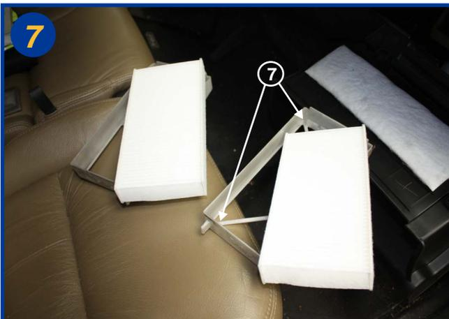
Sortir les éléments filtrants de leur cadre plastique, procéder à leur remplacement en imbriquant les 2 premiers plis à leurs extrémités dans les nervures (7) prévues à cet effet.
