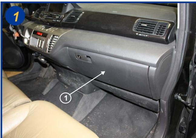
Les filtres d'habitacles sont situés à l'intérieur du véhicule, côté passager derrière la boîte à gants (1).
