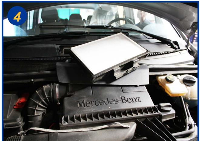
Remplacer l'élément filtrant usagé.
