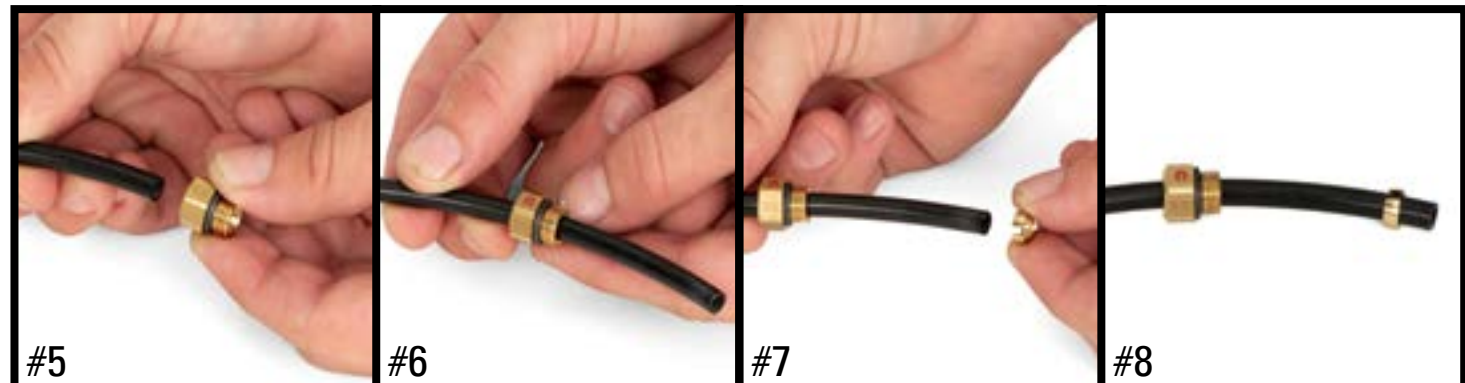
#5 将空气管路插入接头和夹头
