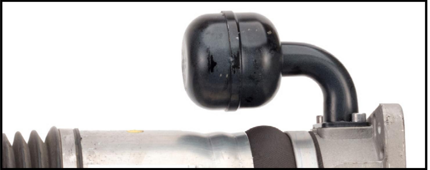
阿尔诺特再制造支柱无需继续使用原有的储气罐。请勿尝试将其拆下并安装到阿尔诺特的产品上。
