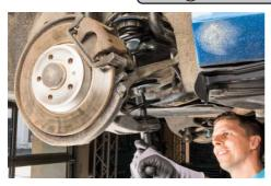
Betätigen Sie die Spindelmutter mit dem Rohr-Doppelsteckschlüssel 4902-24 (S 24mm) bis die Feder ausreichend gespannt ist und entnommen werden kann.
