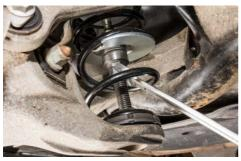
Ist die Spindelmutter nach dem Einsetzen in die Achse nicht mit dem Rohrschlüssel zu erreichen, muss die Spindelmutter des Federspanners mit einem Ring-Maulschlüssel SW 24 durch die Federwindungen entspannt werden.
