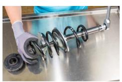
• Nach dem Ausbau entspannen Sie die Feder und entfernen die Werkzeuge.
