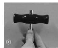
④ Drücken Sie das Drahtende an den Werkzeugschaft und ziehen diesen durch den Griff.
