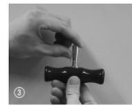
③ Führen Sie den Draht von oben durch die Öffnung.
