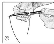
③ Voer de draad van boven door de opening bij de schroef.
