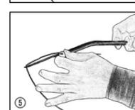
⑤ Fixieren Sie den Draht durch Drehen der Rändelschraube.
