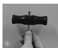
④ Druk het draadeinde in de gereedschapschacht en trek het door de greep.
